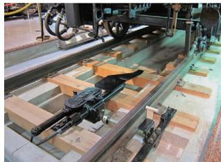
写真：営団地下鉄で使用された「打ち子式 ATS」。地下鉄博物館の展示物。撮影 Rs1421。
